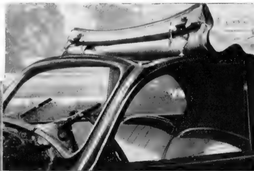
Ci-dessus : la « découvrable » 202 à ciel ouvert. Ci-contre : le système spécial pour tendre la capote.
